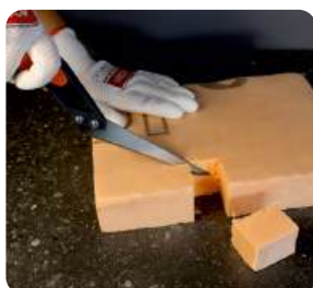
арт. 113-140 для среза пены, пенопласта, утеплителя
