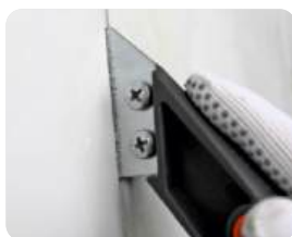
Для финишной очистки торцов плитки
